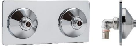
Platine de lavabo R-Fix® de marque Riquier® avec raccords pour PER visible (raccords à sertir ou à glissement), d'entraxe 120 mm en sortie mâle 3/8 ou Femelle 1/2. (Modèle droit, coudé, pour PER 12 ou 16 au choix). Livré avec 2 bouchons d'obturation pour les travaux.
